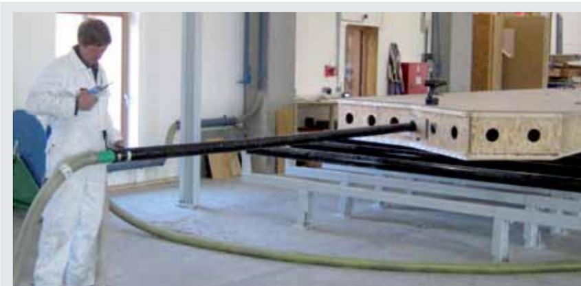
Der moderne Holzbau errichtet ein Gebäude in kürzester Zeit mit vorgefertigten Elementen. Unabhängig von der Witterung werden Wand- und Dachkonstruktionen im Werk hergestellt und auf der Baustelle zusammengesetzt. Isocell hat für Betriebe mit hohem Vorfertigungsgrad die ISOBLOW Großballenanlage entwickelt. Die Zellulose wird in Großballen von 270 kg angeliefert und in die Holzrahmenelemente mit sogenannten Lanzen gefüllt.
