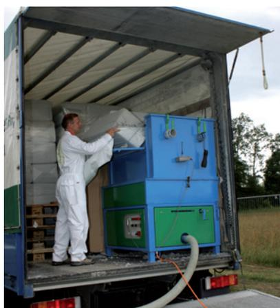
Un assistant verse l'isolant cellulose ISOCELL dans la machine installée dans le camion.
