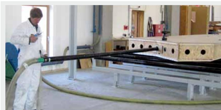
Les parois préfabriquées en bois permettent d'ériger un bâtiment en un minimum de temps. Indépendamment de la météo, les éléments muraux, de sols et de toitures sont préassemblés en usine et montés sur chantier. Pour les entreprises de construction à haut niveau de préfabrication, ISOCELL a mis au point une machine d'insufflation ISOBLOW pour de gros ballots. La cellulose est livrée sous forme de gros ballots de 270 kg et insufflée dans les squelettes en bois au moyen d'une lance spécifique.
